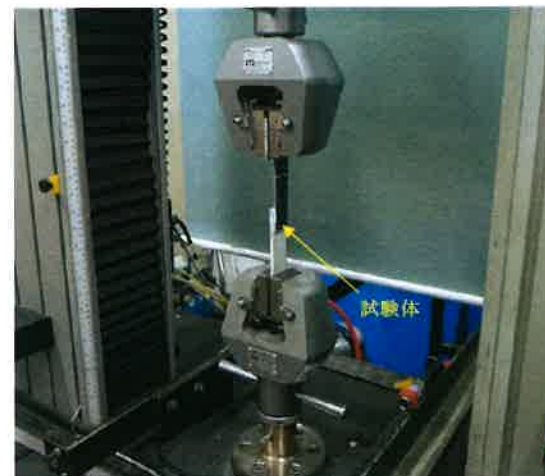
写真4 試験体設置状況の一例（せん断強さ）
